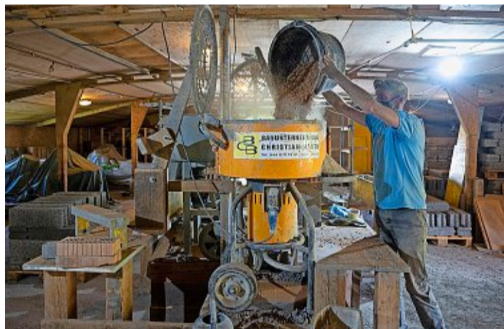
Rein mit den geschredderten Korkzapfen: Martin Bichsel bei der Produktion der Kork-Lehm-Steine.
